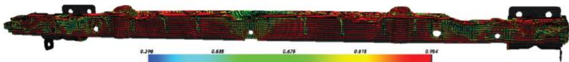
图 3: 前端模块中纤维方向通过 moldflow 仿真, 并映射到结构网格上来获取材料局部的刚度和失效特性
