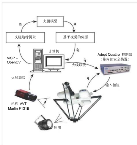
用来验证 Adams-Simulink 协同仿真的实验设置
