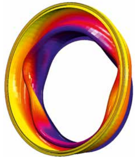
Nicht-lineare Berechnung der Gummidichtung einer Waschmaschine.
