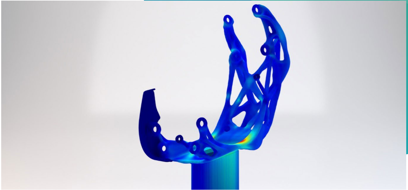
図1: シミュレーション結果では部品全体において均一な応力分布となっていることが同色(青/ターコイズ)で示され、クリティカルエリア(赤)は殆どありません。
