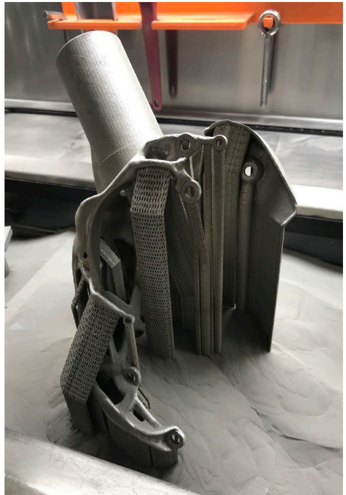
図2: モーター取付具は粉末をレーザーで焼結積層していくSLM(selective laser melting)方式で製造。製造プロセスで必要となるサポート(支持)構造は簡単に除去できるため、取付可能な部品が即座に入手可能です。
