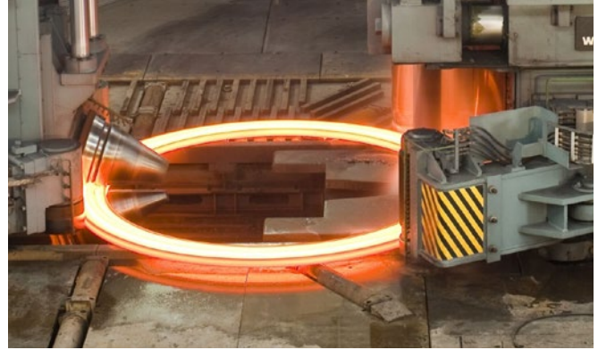
Eine wichtige Aufgabe des Prozessplaners ist die optimale Auslegung des Walzprozesses zur effektiven Produktion fehlerfreier Ringe.
